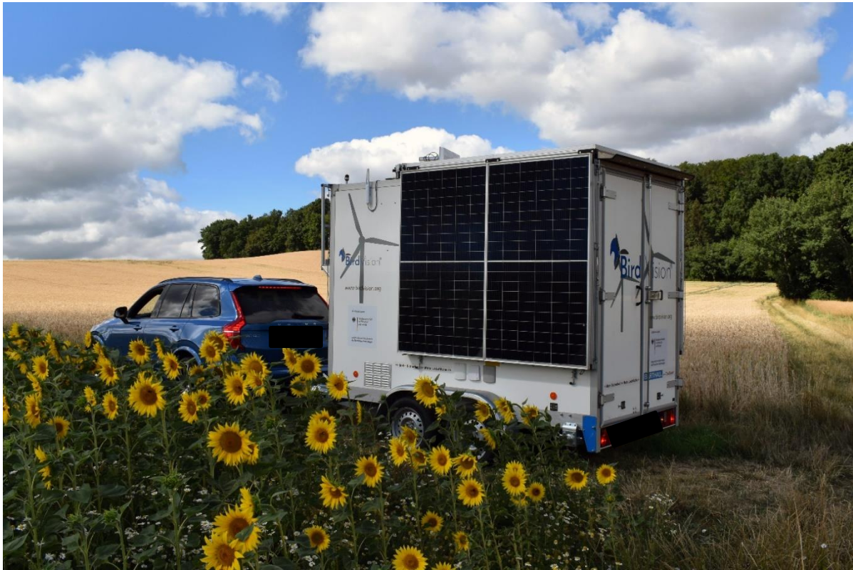
Abbildung 47: Freistehendes Monitoringsystem im fahrbereiten Zustand Quelle: Eigene Darstellung
