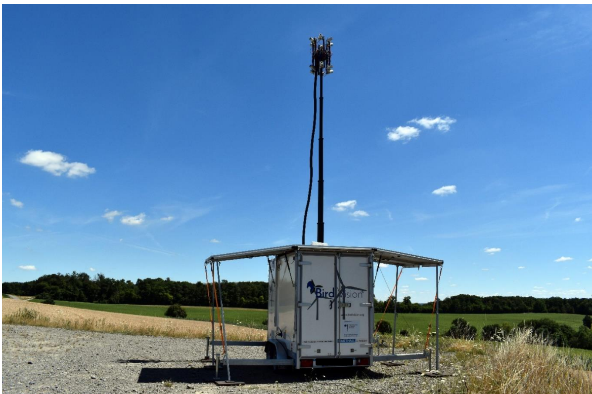
Abbildung 48: Freistehendes Monitoringsystem im aufgebauten Betriebszustand Quelle: Eigene Darstellung
