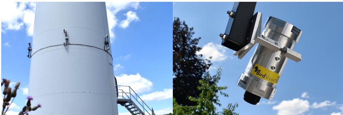
Abbildung 2: Kamerasystem mit sechs Paaren am Turmfuß (links) und Blick auf das Kameraschutzgehäuse aus Aluminium (rechts)
